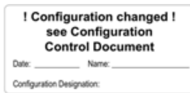
Figura 15: La nueva identificación de configuración especial "configuración cambiada" debe colocarse junto a la etiqueta existente.
