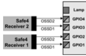
Figura 10: Conexión de hasta dos componentes de seguridad OSSD (por ej., sistemas de cortina de luz GuardShield Safe4)
