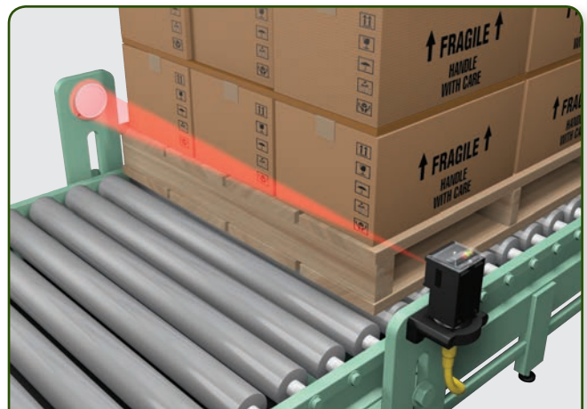
Manejo de materiales – Los sensores fotoeléctricos, como los Series 9000, se usan en todas las etapas del proceso de envasado para confirmar la presencia y la posición del contenedor.
