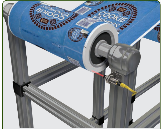
Detección de rollo – Un LaserSight 42CM monitorea un rollo de película para indicar un bajo nivel de la película.
