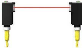
Sensores fotoeléctricos de haz transmitido tradicionales – Un solo haz detector
