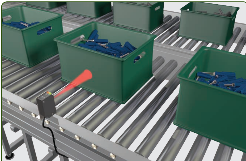
Transportadores paralelos – Un detector 42BT con supresión del plano de fondo es capaz de detectar bandejas en el transportador cercano y a la vez ignorar las bandejas en el transportador lejano.
