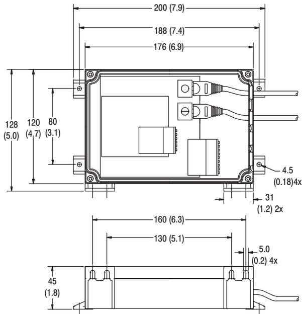
**Nota:** El controlador puede montarse ya sea en un riel DIN usando soportes de montaje en la parte posterior, o con cuatro tornillos a través de los agujeros en las lengüetas que se extienden desde las esquinas del envoltorio.
