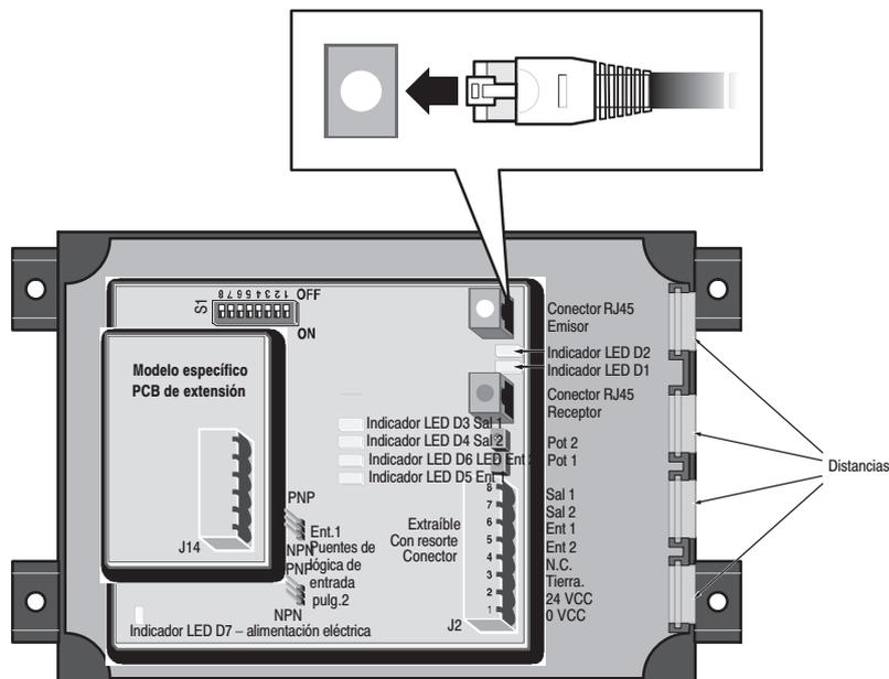
El conector J2 en la CB base tiene la siguiente configuración de pines para todos los modelos de controlador.
