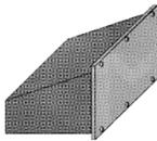
A: placa saliente del Bumper, con taladros diam. 8,5mm
