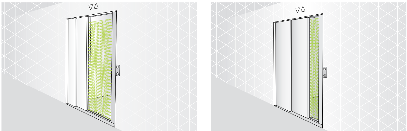
Aplicación en dinámico – haces cruzados activos hasta el completo cierre de la puerta
