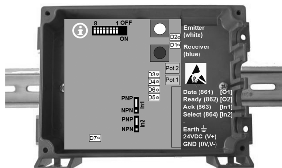
Figura 14 - Indicador de estado (D1 a D7) y puentes J1 y J2
