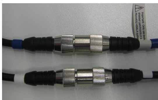
Figura 13 - Conexiones M12 para el transmisor (blanco) y el receptor (azul)
