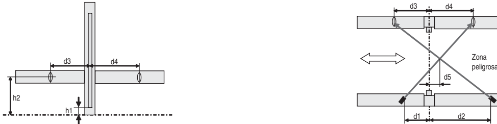
Figura 20: La distancia d5 debe ser tan corta como sea práctico, para evitar que las personas ingresen a la zona peligrosa sin ser detectadas inmediatamente después de la paleta o del sistema de transporte. El punto de cruce del haz de muting tiene que estar en la zona peligrosa.
