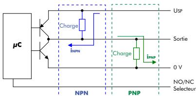
Raccordement à la charge Rx :
