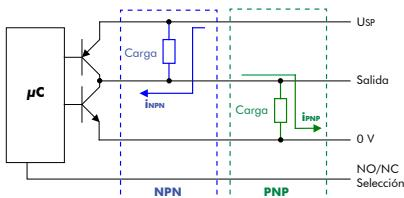
Conexión del cable Rx de la carga:
