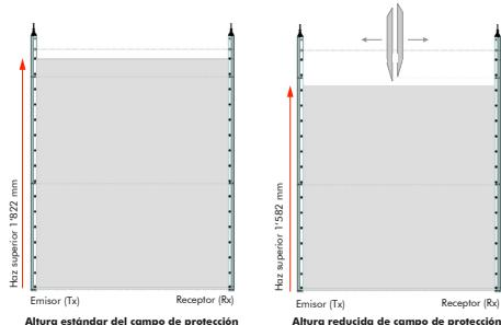
Conexión del cable Tx para la altura estándar del campo de protección: **1'822 mm**
