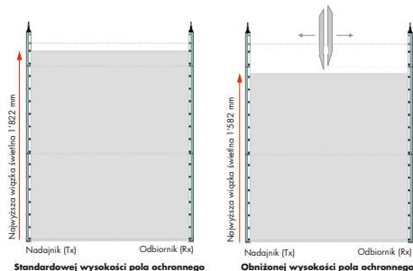
Podłączenie przewodów kabla Tx dla standardowej wysokości pola ochronnego: **1822 mm**
