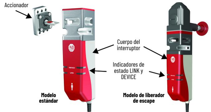
El interruptor de seguridad con bloqueo Guardmaster® 440G-MZ bloquea una puerta de guarda en la posición cerrada y no la libera hasta que las funciones peligrosas de la máquina que están cubiertas por la guarda se encuentran en una condición segura. El sistema de control de seguridad solo permite que funcionen las funciones peligrosas de la máquina cuando la guarda está cerrada y bloqueada.
