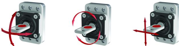
El accionador flexible se flexiona, gira y se desliza para compensar por el desalineamiento de la puerta de guarda (Figura 3). Para lograr un rendimiento óptimo, compruebe que el perno de bloqueo puede entrar y salir del accionador de lengüeta sin atascarse. Se recomienda el uso de un pestillo de puerta montado por separado para evitar el desalineamiento de la puerta.
