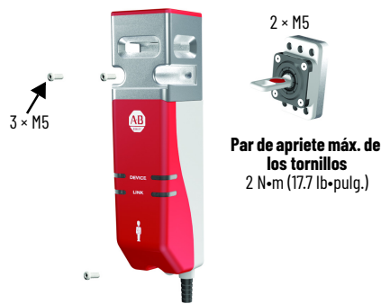
Figura 4 - Piezas de montaje necesarias para el interruptor y el accionador
